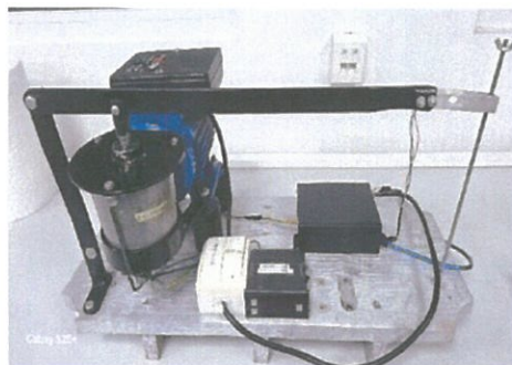
Stand demonstrativ pentru determinarea transmisiei în flux de energie deschis, ce utilizează motoare și generatoare cu stator oscilant, realizat în cadrul Cercului de automatizări în anul 2023.
