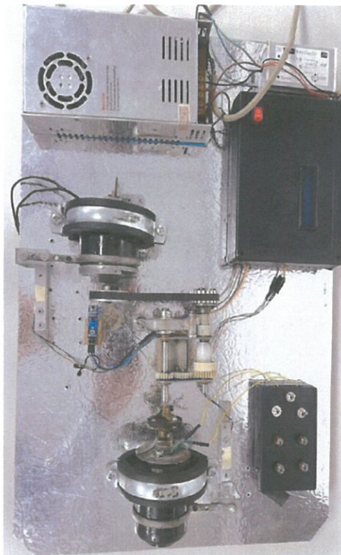
Stand demonstrativ pentru determinarea transmisiei în flux de energie deschis, ce utilizează motoare și generatoare cu stator oscilant, realizat în cadrul Cercului de automatizări în anul 2023.
